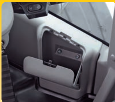
Geïsoleerde opbergruimte voor warme of koude levensmiddelen
