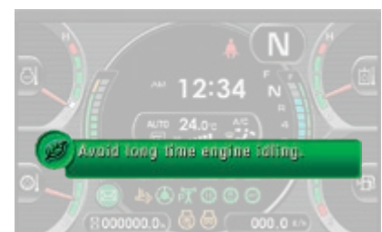
De eco-functie zorgt voor energiebesparingen in real-time (bv. langdurig stationair draaien van de motor vermijden)
