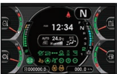
Informatie in één oogopslag: basisdashboard met LCD-monitor
