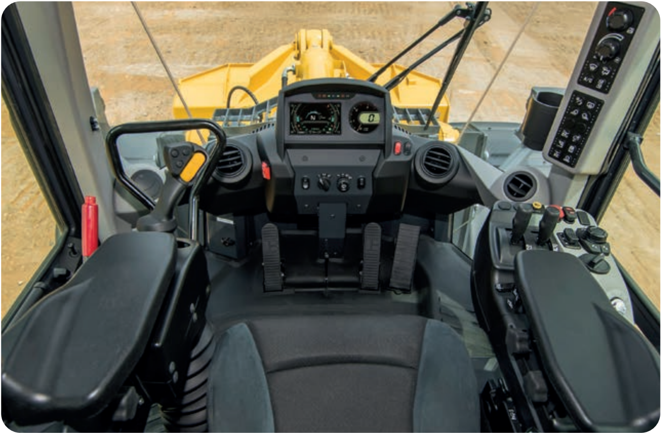
De afbeelding toont de geavanceerde joystickbesturing (AJSS) (optie)
