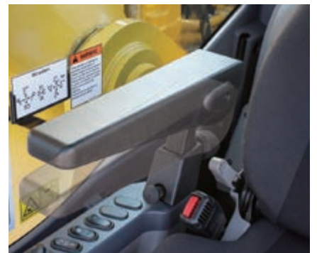
Accoudoir aisément réglable en hauteur
