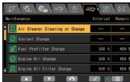
Via de multifunctionele monitor kan een schat aan operationele en onderhoudsinformatie worden bekeken en beheerd
