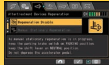
Nabehandelingssysteem-regeneratiescherm voor de KDPF
