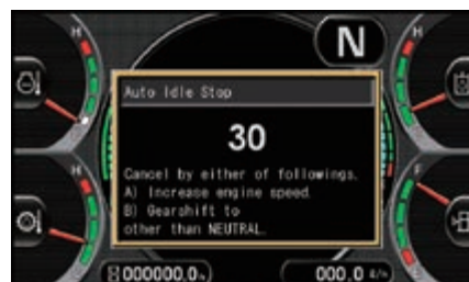
De instelbare motorstop zorgt ervoor dat de motor na een gekozen periode van stationair draaien automatisch wordt uitgeschakeld.
